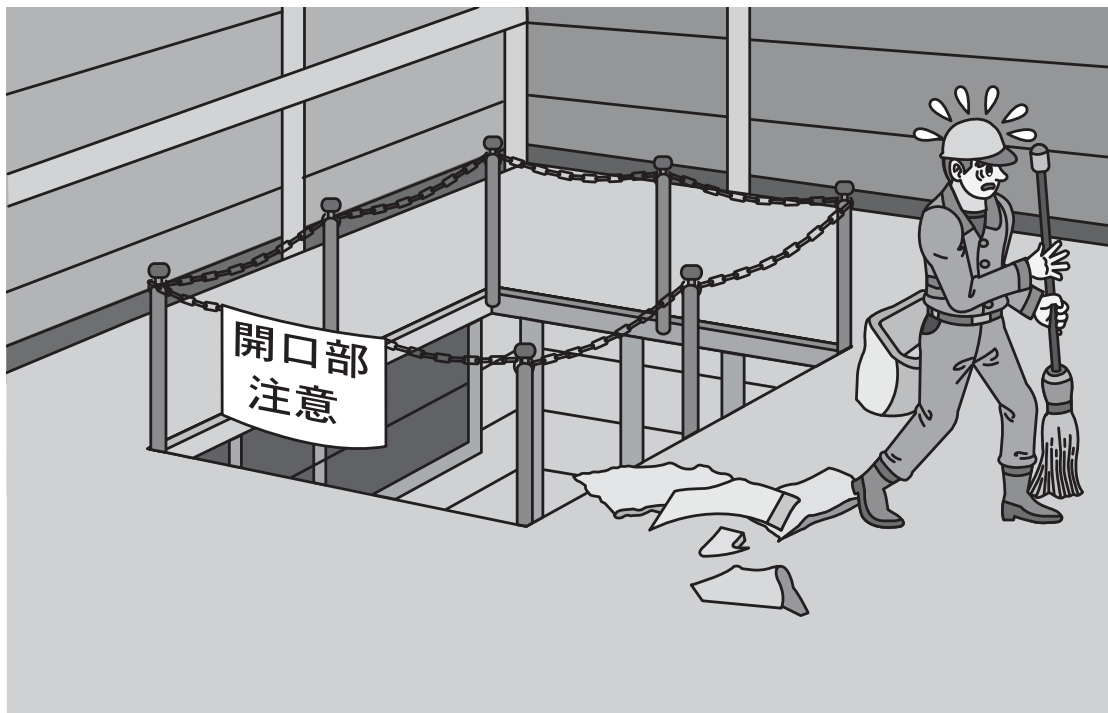
図表A 4-6 開口部付近の清掃作業の例
