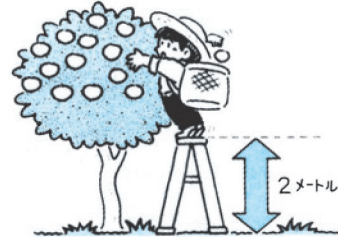
イ 高さが2メートル以上の箇所での作業
