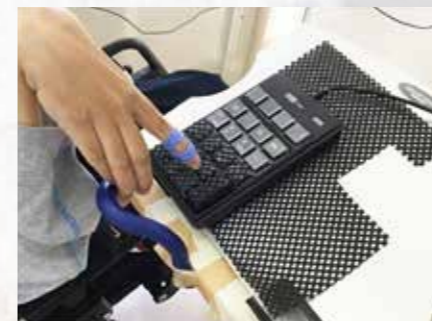
サンワサプライ プログラマブルテンキー NT-19UH2BK Autohotkey(フリーソフト) 外付けのテンキーのキーボード。ソフトと組み合わせて、あまり使わないキーを他のプログラムに割り当てている。
