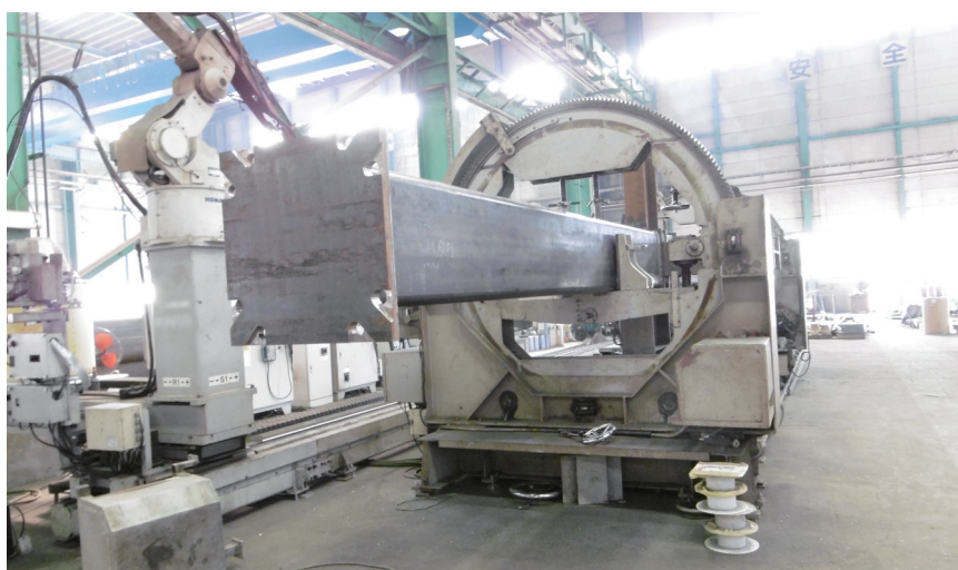
工場の自動化設備 (重量物を機械で反転させロボットが溶接)
